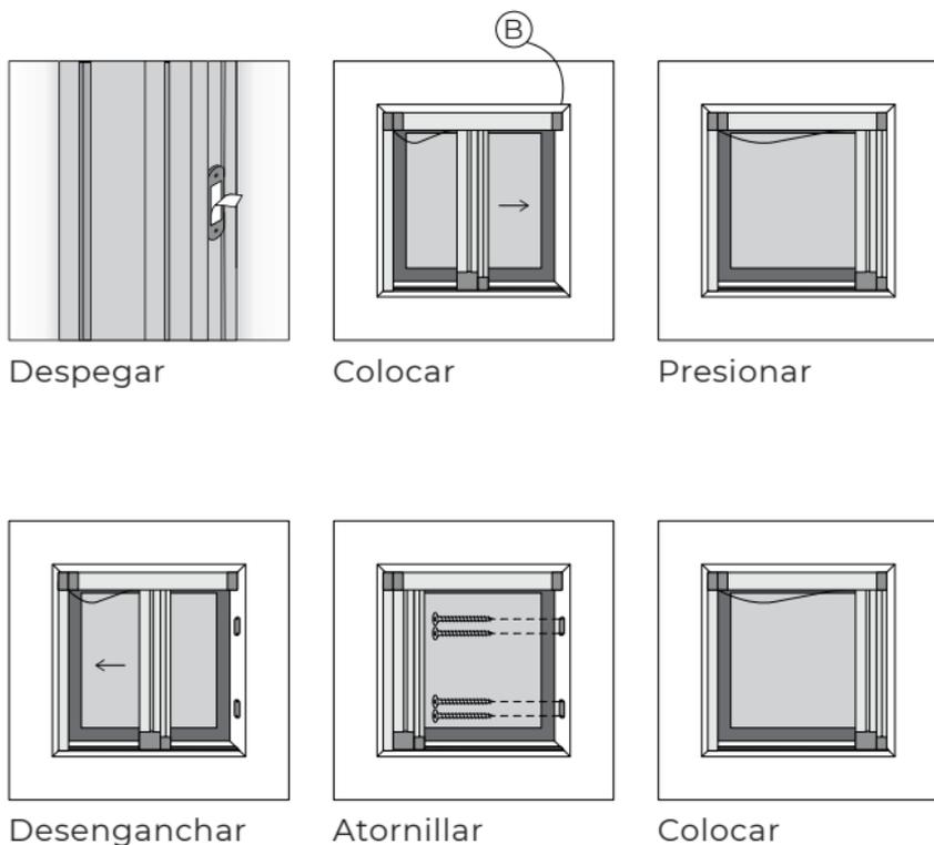
Repetimos el proceso al otro lado, quitamos las capas protectoras de los anclajes presentes en el perfil de la mosquitera. Lo colocamos en el lado B y presionamos para que los anclajes se peguen. Desenganchamos\* la mosquitera dejando pegados los anclajes y los atornillamos.
