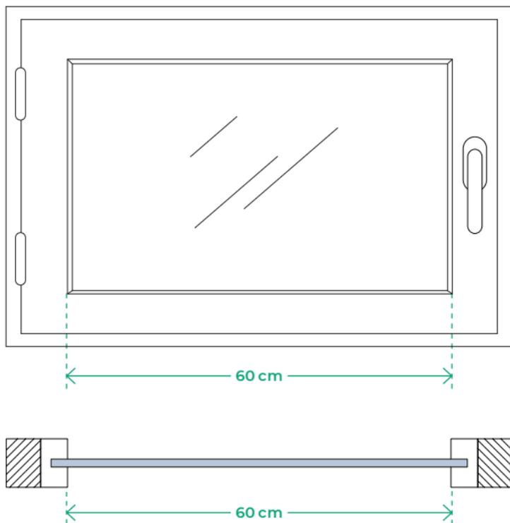
Medimos y apuntamos el ancho entre los junquillos laterales de la ventana, en este caso, 60 cm. En la web de Cortinadecor, rellenaremos **sólo el ancho A** y no hará falta rellenar el ancho B.
