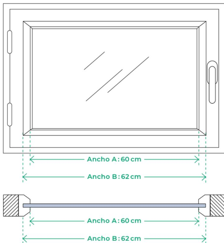
Medimos y apuntamos el ancho inferior (ancho A), en este caso 60 cm y el ancho superior, marcado por el bisel (ancho B), en este caso 62 cm. En la web de Cortinadecor, rellenaremos el ancho A y el ancho B.
