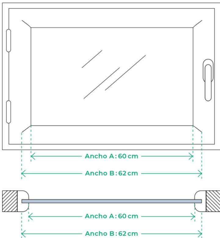
Medimos y apuntamos el ancho inferior (ancho A), en este caso 60 cm y el ancho superior, marcado por el final del arco (ancho B), en este caso 62 cm. En la web de Cortinadecor, rellenaremos el ancho A y el ancho B.
